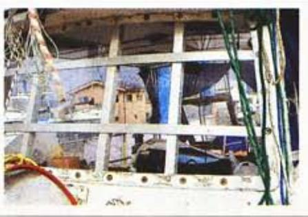
シュテンドウジIIIのキャビン前部の窓。強烈な波、風に備え、アルミの枠で補強されている
